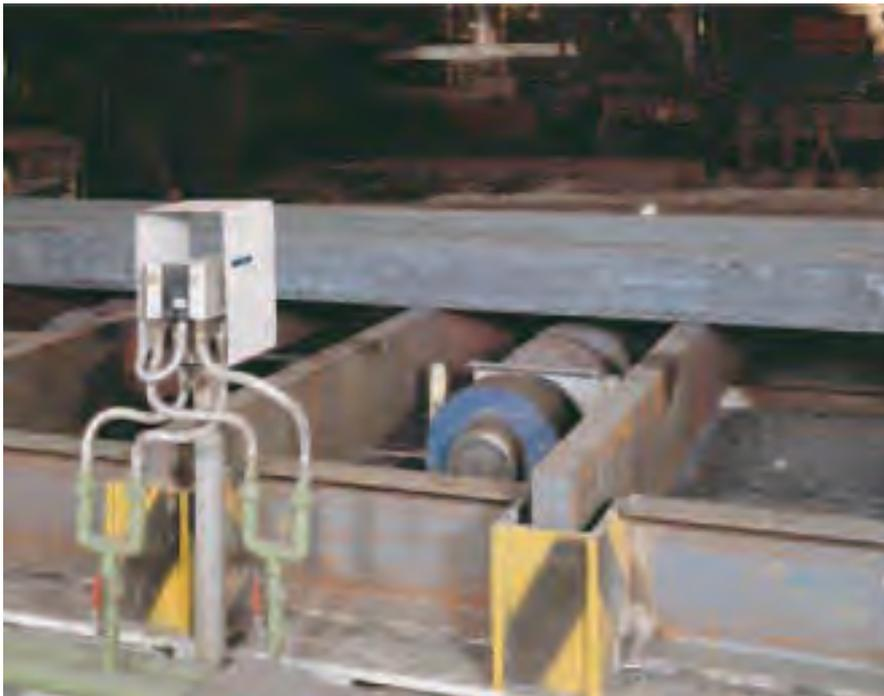
▶ 在轧钢厂中，钢鳞、蒸汽和高温都不会影响WT45—此时它正在检测钢板的存在。
